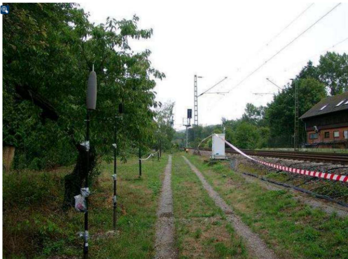
In Kestert und in Brey wurden spezielle Sensoren in den Gleiskörper eingebaut, die Informationen über den Einfluss von Radformfehlern auf den Lärmpegel geben sollen. Mikrofone liefern weitere Daten.
